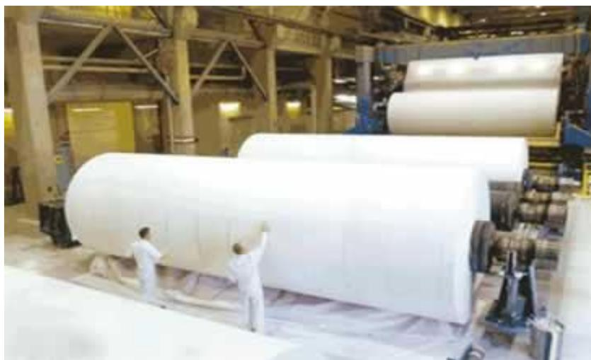
Depois de enrolado, o papel passa por bobinas que irão cortá-lo seguindo padrões de tamanho e gramatura. Depois, as máquinas empacotadeiras separam a quantidade de folhas em cada pacote, e colocam cada pacote em caixas.
